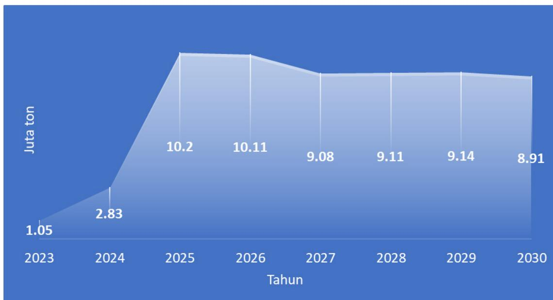
**Gambar 2.** Kebutuhan Biomassa untuk Proses Cofiring di Indonesia, 2023-2030
